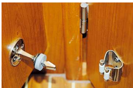
Die Türschnapper im Wohnbereich der 40 AC sind vorbildlich solide ausgeführt
